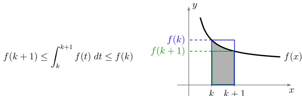
Sur le dessin cette inégalité signifie que l'aire sous la courbe, entre les abscisses  $k$  et  $k+1$ , est comprise entre l'aire du rectangle vert de hauteur  $f(k+1)$  et de base 1 et l'aire du rectangle bleu de hauteur  $f(k)$  et de même base 1.
