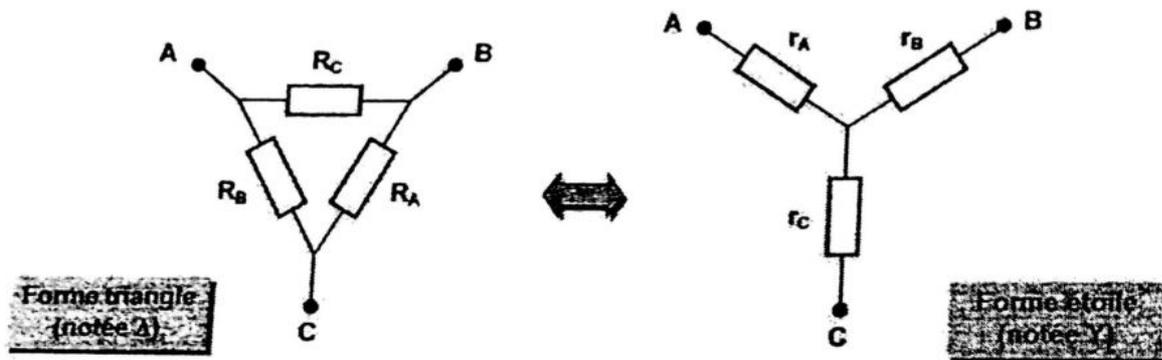
On passe d'un montage **triangle** à un montage **étoile**, en calculant les résistances  $r_A$ ,  $r_B$  et  $r_C$  :
