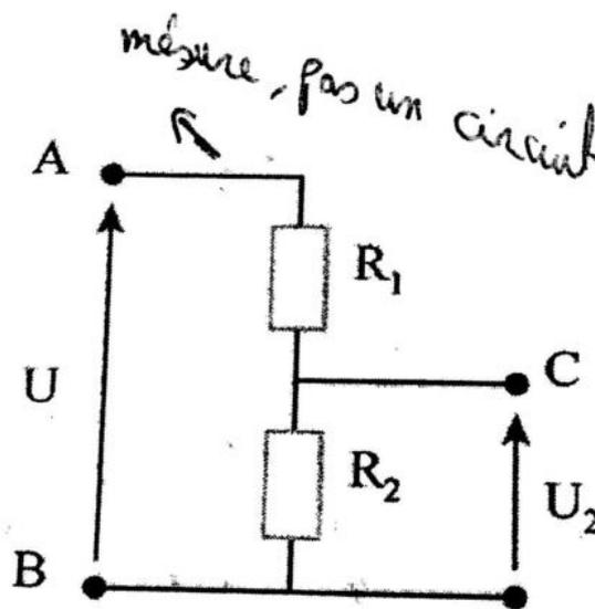
La tension de sortie peut être exprimée en fonction de la tension d'entrée et les valeurs des caractéristiques des dipôles ; dans notre cas ce sont des résistances, donc :
