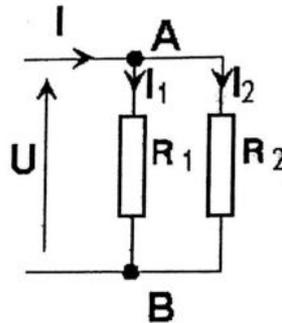
Le courant  $I_2$  peut être exprimé en fonction de courant d'entrée et les valeurs des caractéristiques des dipôles :
