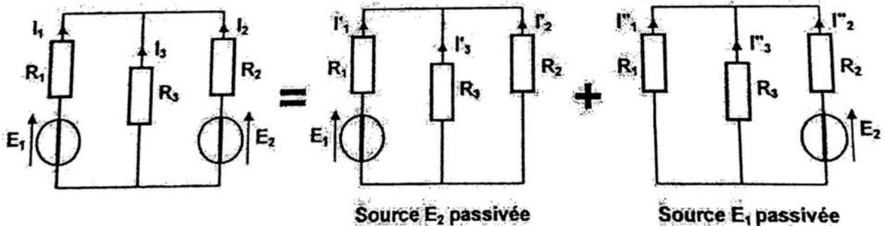
Il faut éteindre toutes les sources sauf une et effectuer le calcul la grandeur : tension aux bornes de la charge ( ou l'intensité dans la branche de la charge) , refaire l'opération jusqu'qu'il ait autant de grandeurs calculées que de sources indépendantes.
